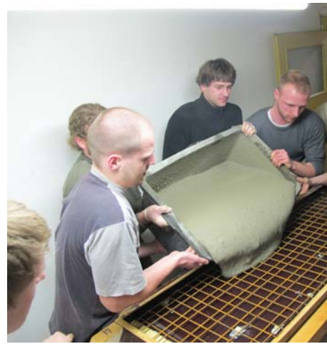
Bild 16: Einfüllen von 65 L selbstverdichtenden Mörtel in die Regelsegmentform
