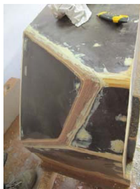
Bild 10: Umbau einer Regelsegmentform für die Lisenensegmente.
